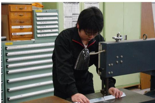
コンターマシンでの材料の切断
